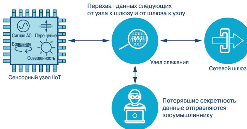
**Рис. 3. Схематическое изображение атаки в точке доступа в сеть между сенсорным узлом и шлюзом**
