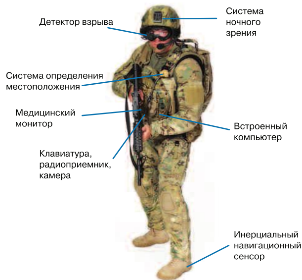
Рис. 1. Встроенная в униформу система жизнеобеспечения современного бойца
