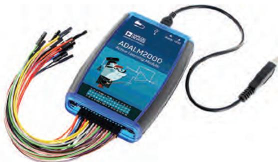
Рис. 1 Внешний вид многофункционального измерительного прибора ADALM2000
