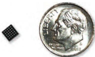
**Рис. 1. Сверхминиатюрная микросхема источника питания типа LTM8074**
