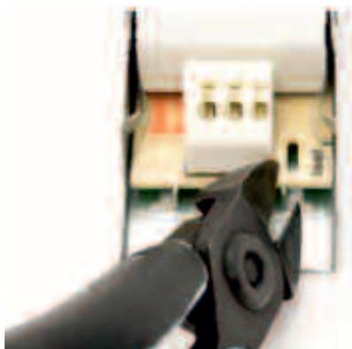
Рис. 12. Вариант устранения перемычки
