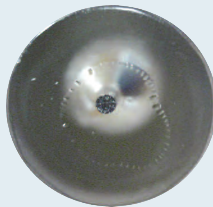
Рис. 7. Фермент, нанесенный на поверхность мембраны биосенсора
