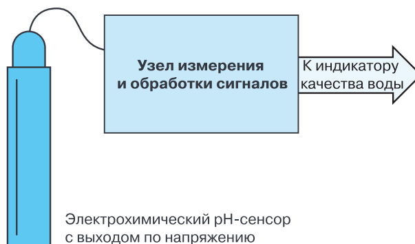
Рис. 1. Структура типовой измерительной системы на основе электрохимического pH-сенсора
