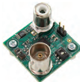
Рис. 5. Оценочная плата с микроконтроллером ADuCM355 для измерения pH и температуры раствора
