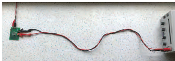
Рис. 2. Соединительные провода между источником питания и нагрузкой скручены в виде витой пары
