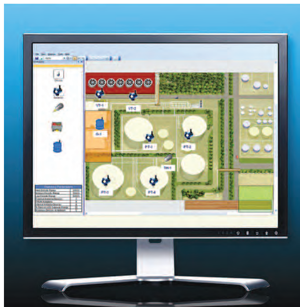
Рис. 2. ПО для управления БСС (Emerson Process Management) обеспечивает мониторинг работоспособности сети с помощью программной утилиты SNAP-ON
