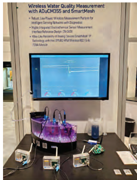
Рис. 9. Фрагмент беспроводной сенсорной сети для мониторинга качества воды
