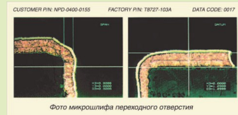
Фото микрошлифа переходного отверстия
