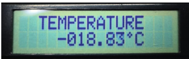
Рис. 3. Измеренная сенсором ADT7320 температура в морозильной камере равна -18.83\text{ }^{\circ}\text{C}
