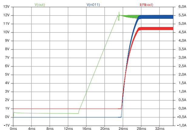
Рис. 3. Временные диаграммы напряжения на выходе преобразователя (зеленая), на нагрузке (синяя) и тока в нагрузке
