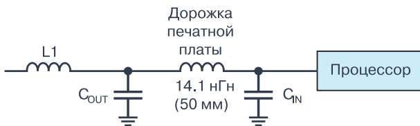
Рис. 3. LTspice модель печатной платы с параметрами индукции проводниковой дорожки
