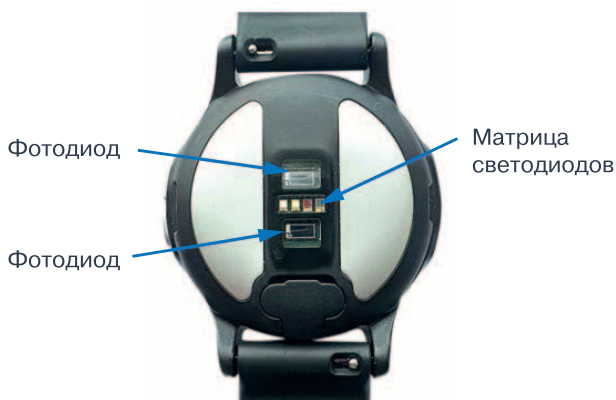
Рис. 5. Часы компании Analog Devices с матрицей светодиодов для измерения сатурации
