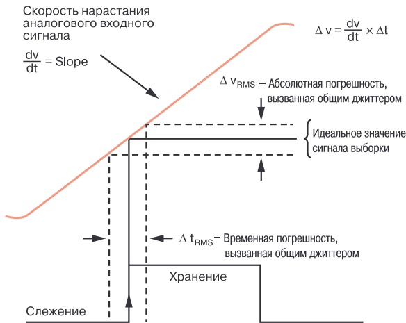
Рис. 12. Диаграмма выборки входного сигнала УВХ с определением погрешности, вызванной общим джиттером тактового сигнала
