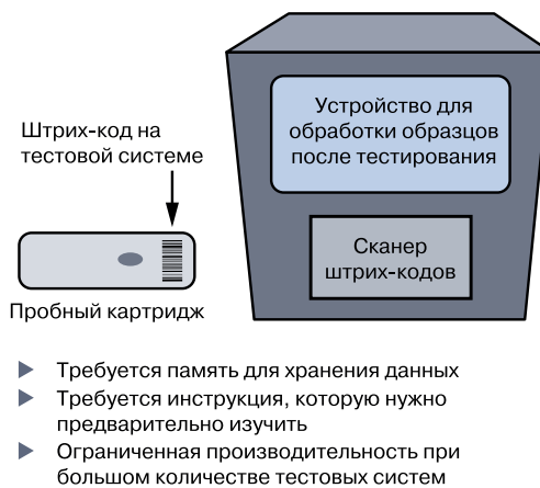
Рис. 1. Устройство для обработки образцов после тестирования с встроенным сканером штрих-кодов
