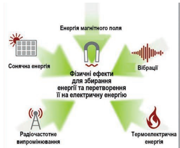
Рис. 2. Приклади збору енергії з навколишнього середовища та перетворення її в електричну енергію
