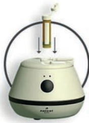
Рис. 5. Крок 1: картридж з наносенсором вставляється у зчитувач
