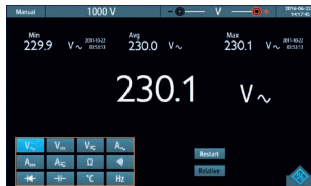
Рис. 8. Відображення вимірюваних мультиметром даних на екрані осцилографа
