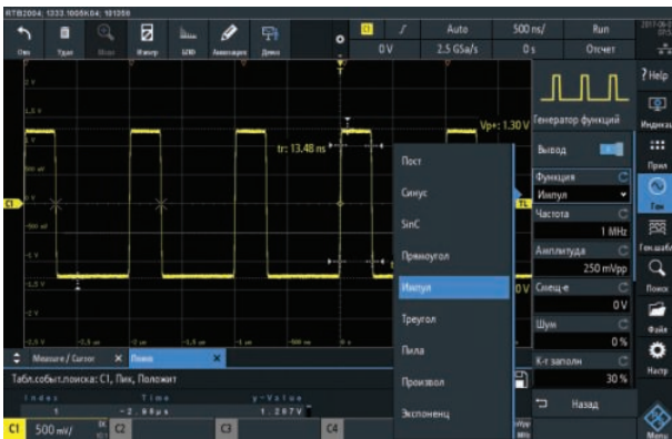
Рис. 6. Меню вибору форми сигналу вбудованого генератора
