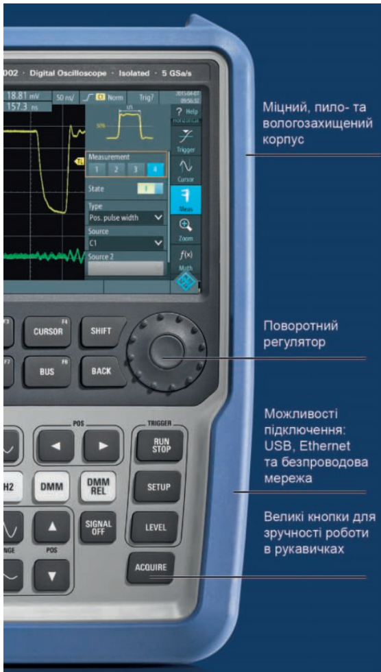
Рис. 5. Фрагмент панелі управління R&S@Scope Rider
