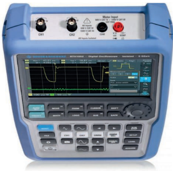
Рис. 3. Розташування входів 2-канальних осцилографів
