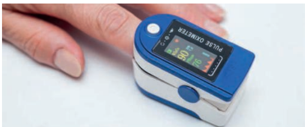
Рис. 2. Пульсоксиметр на пальці нерухомого пацієнта, який вимірює SpO 2
