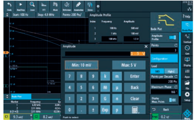
Рис. 12. Вихідний рівень сигналу генератора може змінюватися користувачем під час вимірювання для збільшення відношення сигнал/завада
