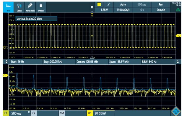
Рис. 8. Аналоговий сигнал та його спектр на екрані осцилографа
