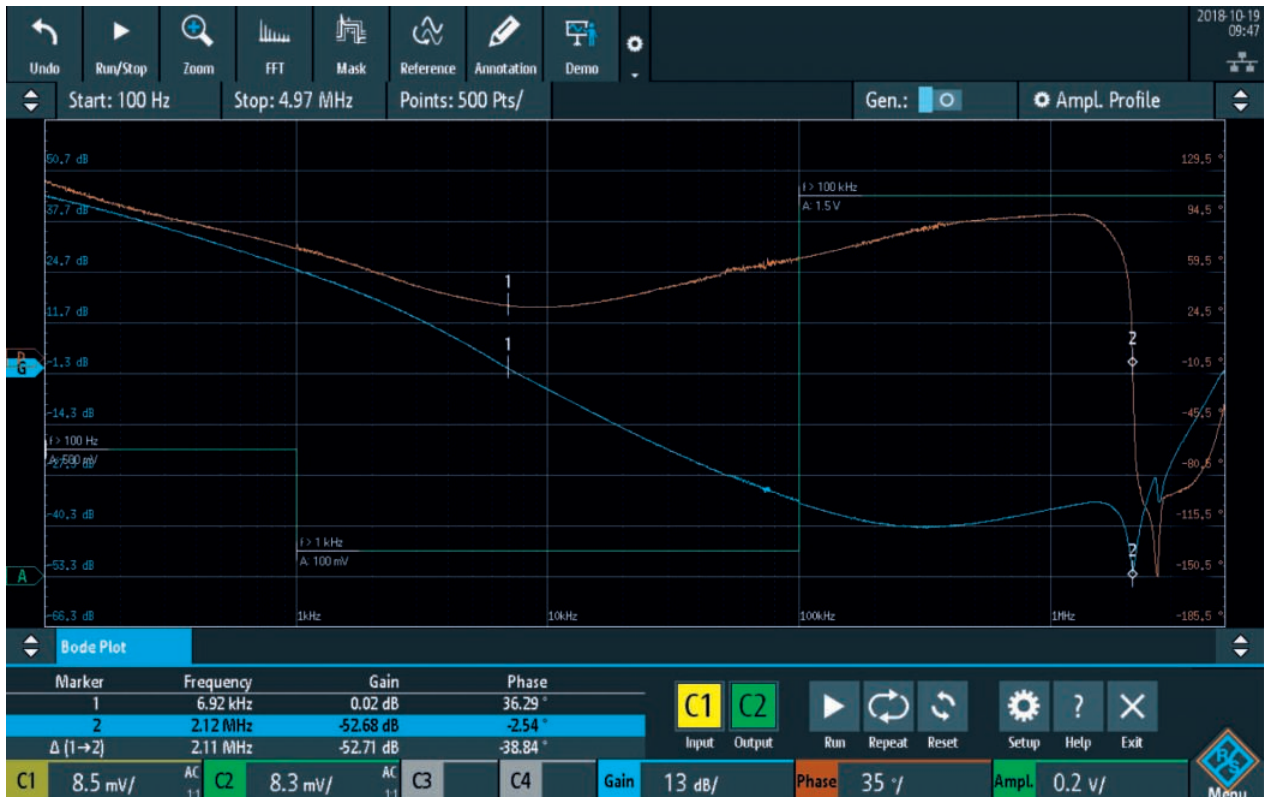
Рис. 11. Відображення АЧХ та ФЧХ при вимірюванні частотних характеристик пристроїв
