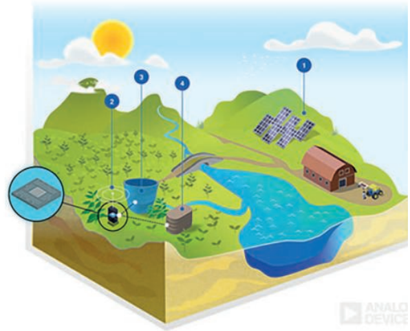
Рис. 2. Структура нової технології вирощування кави, де 1 – сонячні батареї, 2 – сенсорний вузол з вбудованим мікроконтролером MAX78000, 3 – іригаційний насос, 4 – підсистема фертигації (підсистема введення добрив або пестицидів у зрошувальну систему іригації)
