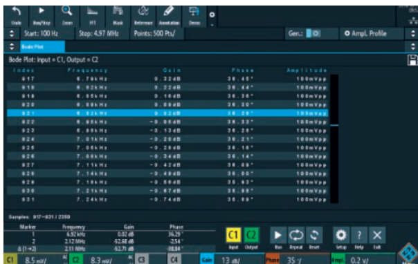
Рис. 14. У таблиці результатів вимірювань містяться докладні дані про кожну виміряну точку, які включають частоту, коефіцієнт підсилення і фазовий зсув
