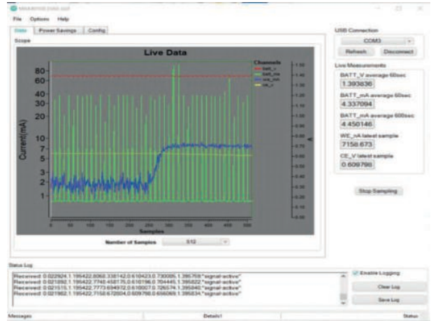
Рис. 6. Результати випробування газоаналізатора при виявленні CO
