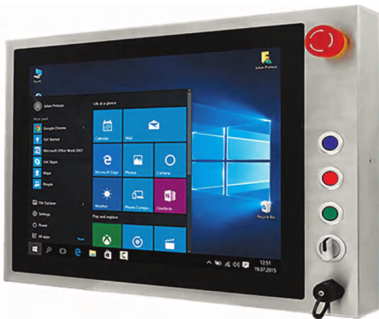
Рис. 6. ПК серії В з кнопками і ступенем захисту IP65
