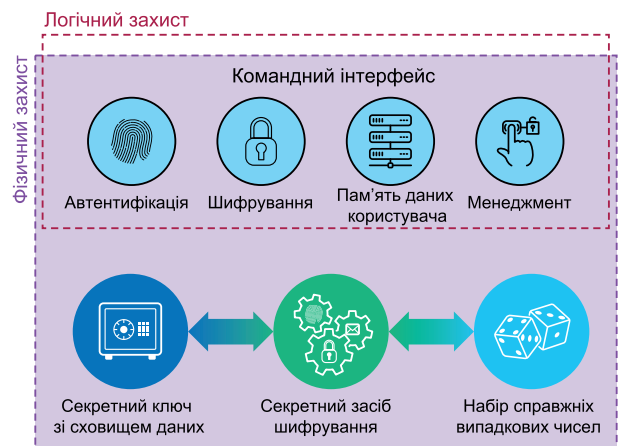
Рис. 1. Концепція апаратного захисту "коріння довіри"
