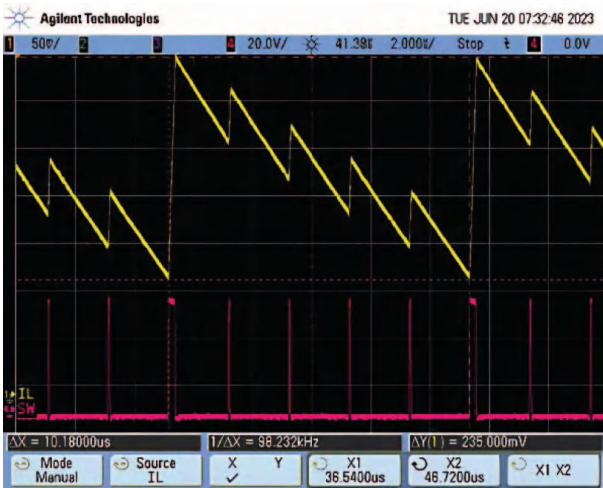
Рис. 4. Осцилограма струму з порушенням мінімального часу включення силових транзисторів
