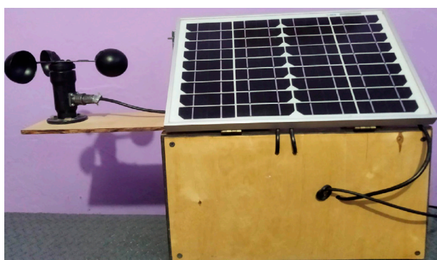
Рис. 11. Автономна метеостанція на базі платформи Arduino
