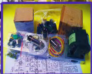
"Двухтактный оконечный усилитель на 6Н23П и 6П43П"
