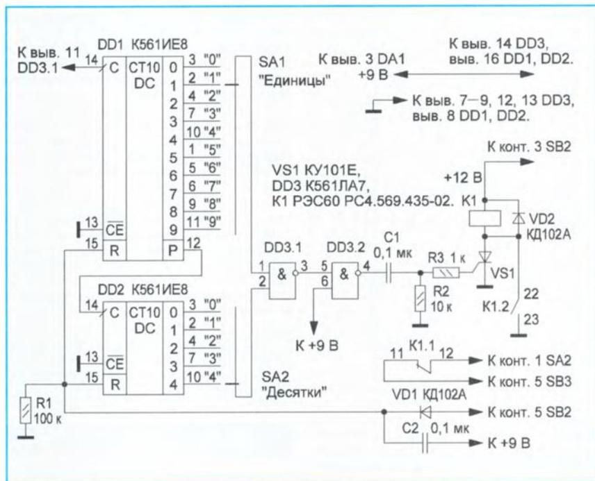
последнем проводе, а на единицу больше. Например, если кабель имеет 20 проводов, то показания индикатора — "21" и светодиод HL1 "Исправен" гаснет, поскольку разрывается электрическая цепь из-за отсутствия 21-го провода. В процессе проверки приходится учитывать, что число проводов в кабеле на единицу меньше и кабель считать исправным.
