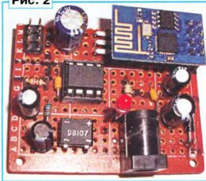
чётности и с двумя стоповыми разрядами. Преобразует пятивольтовый уровень сигнала на выходе микроконтроллера в допустимый для входа URXD модуля ESP-01 трёхвольтовый уровень резистивный делитель напряжения R9R10.
