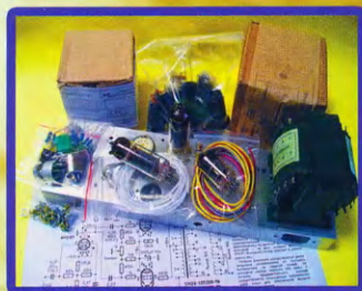
"Двухтактный оконечный усилитель на 6N23P и 6P43P"
