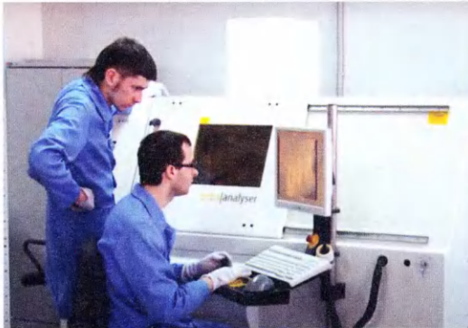
Оптическая инспекция дефектов модулей.
