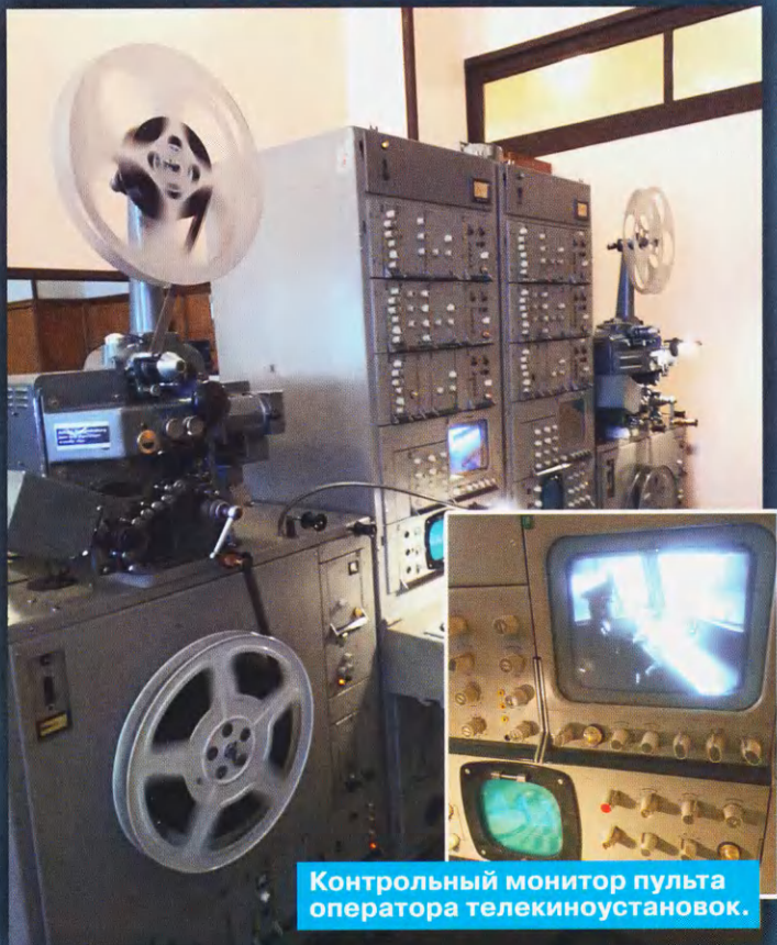
Пульт оператора телекиноустановок.
