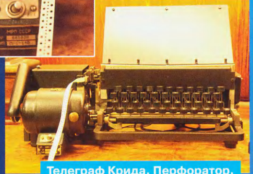
Телеграф Крида. Перфоратор.
