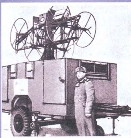
Станция орудийной наводки "Нептун".
