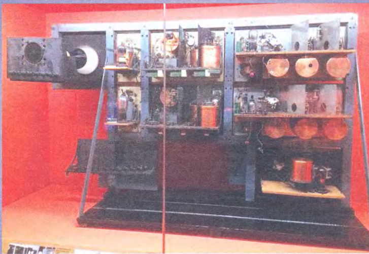
Основной блок радара Watson.
