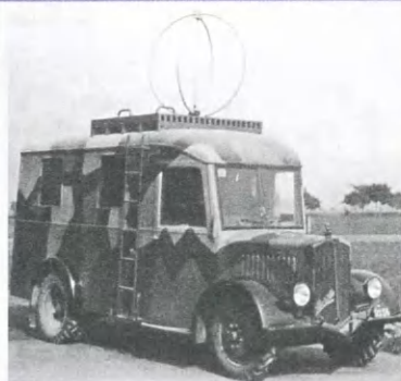
Мобильный вариант пеленгатора выпускался компанией Telefunken с 1938 г. Пеленгатор также использовался в Швейцарии. Тактико-технические характеристики пеленгатора: чувствительность — 1,5...10 мкВ, диапазон частот — 75 кГц...3,33 МГц.
