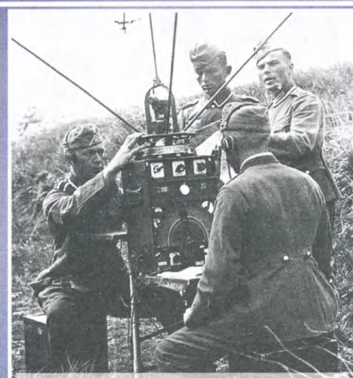
Полевой пеленгатор на базе приёмника EP-2a.
