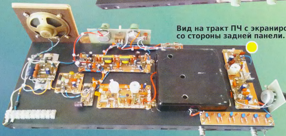
Вид на тракт ПЧ со стороны задней панели. Узел А3 без экрана. Эта конструкция только для проверки развязки цепей питания всех узлов по низкой частоте.
