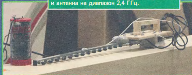
Макет спутника регулярной лиги, приёмник и антенна на диапазон 2,4 ГГц.
