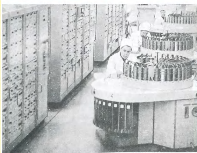
УЧАСТОК СОРТИРОВКИ ГОТОВЫХ ТРАНЗИСТОРОВ НА КЛАССИФИКАТОРАХ КТ2-12
