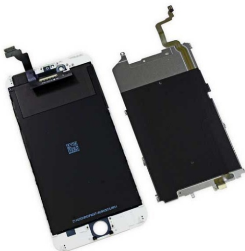
iPhone 6 Plus имеет 5.5-дюймовый экран с разрешением 401 пиксель на дюйм со светодиодной подсветкой и технологией IPS. (Источник: iFixit).
