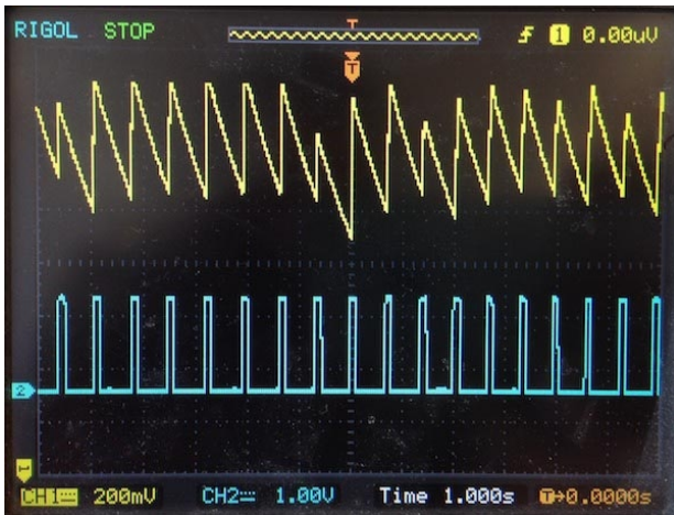
Рисунок 2. Временные диаграммы напряжений в точках COMP (Канал 1) и Pulse (Канал 2).
