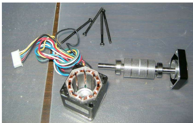
Рисунок 2. Типовая конструкция гибридного шагового двигателя.
