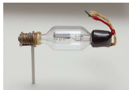
Аудион – первый прибор для усиления электрических сигналов
