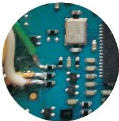
Рисунок 4. Места припайки проводов для подключения светодиодов (справа); то же в увеличенном виде (слева).
