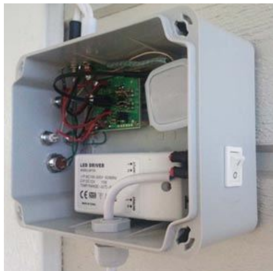
Рисунок 8. Корпус системы, установленный на внешней стене дома.
