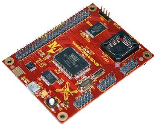
W65C265SXB микроконтроллерная плата на основе 65C816.
