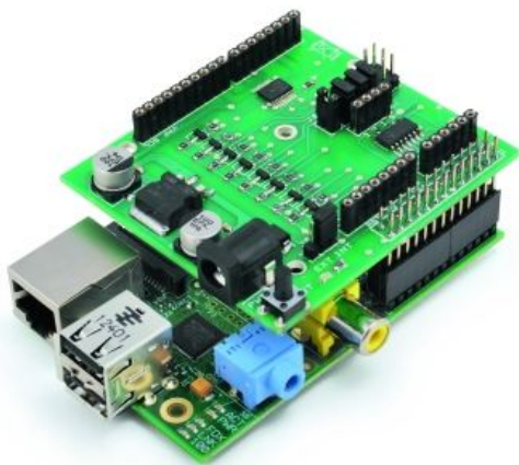
Рисунок 1. Плата расширения GPIO Shield для Raspberry Pi, совместимая с Arduino.
