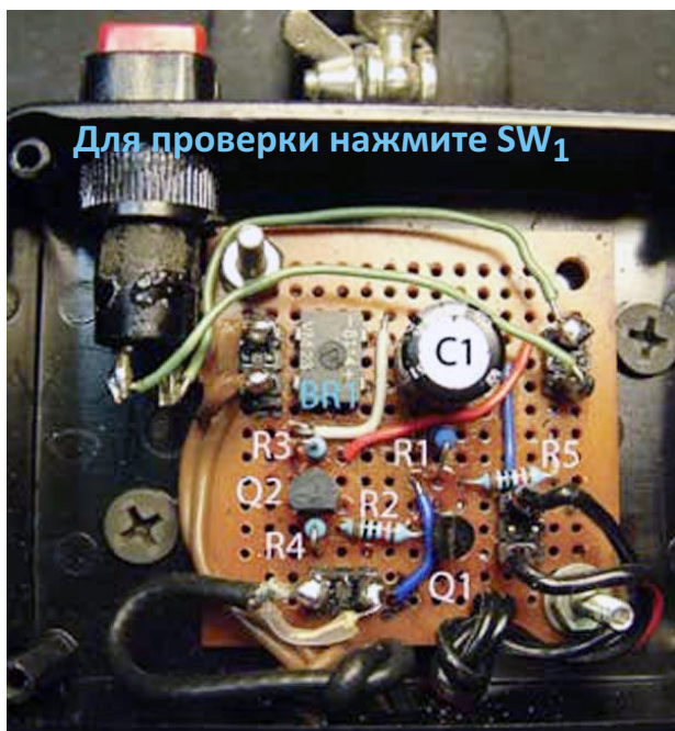
Рисунок 2. В схеме имеется кнопка для проверки ее работоспособности.
