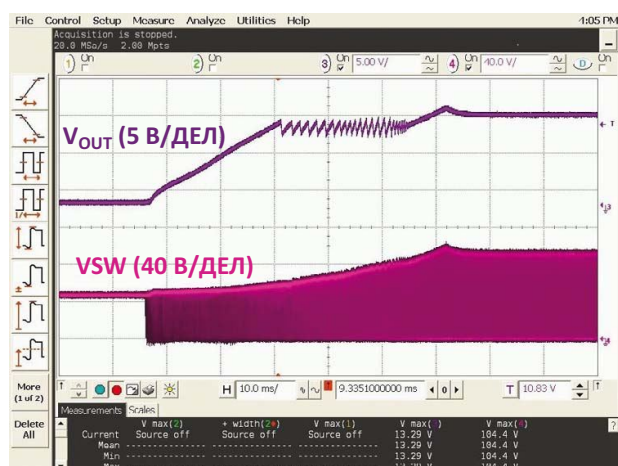
Рисунок 1. Выходное напряжение прямоходового преобразователя в режиме запуска при питании системы, включающейся при напряжении 10 В. Видно циклическое включение системы и выбросы на выходе, достигающие примерно 10%.
