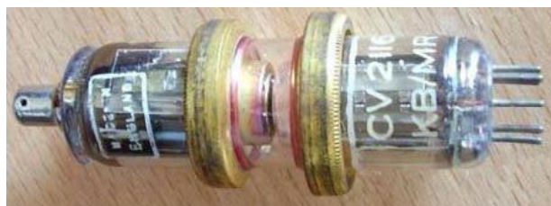
Рисунок 4. Отражательный клистрон CV2116. (Фото из частной коллекции Роя Джонсона).
