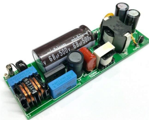
DER-637 – типовой образец 35-ваттного изолированного обратноходового драйвера светодиодов с корректором коэффициента мощности.
