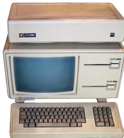
Apple Lisa с установленным наверху жестким диском ProFile. (Фото: Stahlkocher/GNU Free Documentation License).
