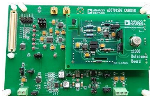
Рисунок 8. Оценочная плата EVAL-AD5791SDZ с платой источника опорного напряжения на основе LTZ1000.
