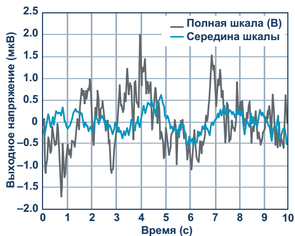
Рисунок 6. Шумы напряжения в полосе от 0.1 Гц до 10 Гц.
