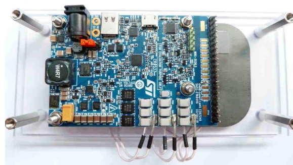
Оценочный набор передатчика трехкатушечного 15-ваттного беспроводного зарядного устройства стандарта Qi на основе микросхемы STWBC-MC.
