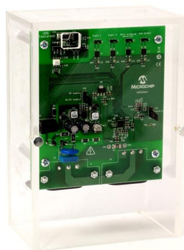
Демонстрационная плата монитора потребляемой мощности на основе MCP39F511A (ADM00667).
