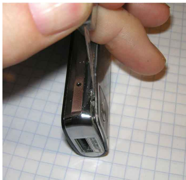
Рисунок 2. Крышка приклеена к корпусу.
