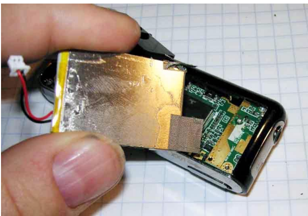
Рисунок 4. Li-ion аккумулятор снабжен плетеной металлической заплаткой, защищающей от помех.
