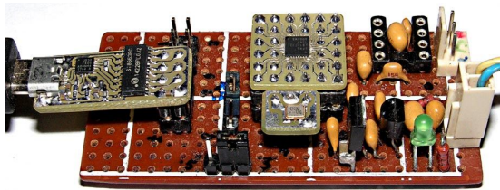
Рисунок 15. Подключение преобразователя SI8663-DIP (Рисунок 11) и кварцевого генератора SG-8002SE (72 МГц, разводка Рисунок 10б) к плате с EFM8LB12 (разводка переходника Рисунок 8).
