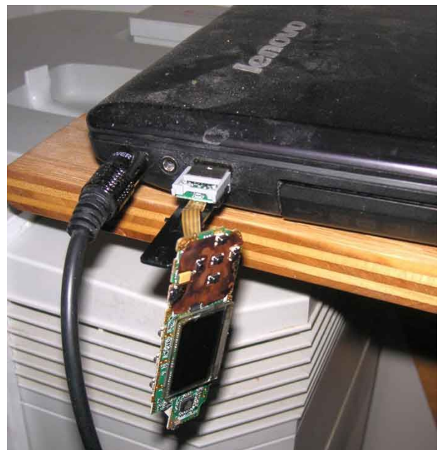
Рисунок 9. С болтающимися внутренностями плеер как флеш-память по-прежнему работает, несмотря на неисправность системы зарядки.
