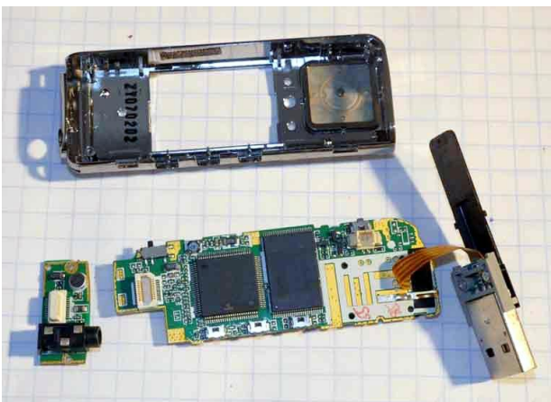
Рисунок 8. Выдвижной разъем USB и межплатный соединитель делают сборку этой конструкции дорогой.
