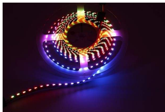
Рисунок 1. Полоса светодиодных модулей WS2812B, отображающих разные цвета.
