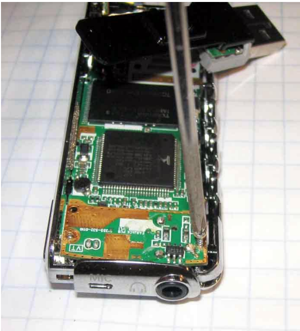
Рисунок 7. Гнездо для наушников установлено на маленькой мезонинной плате.
