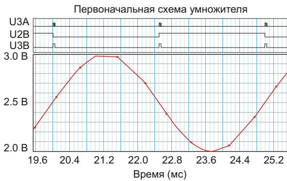
Рисунок 2. Недостатком схемы является тенденция к иницированию умножения на два в нижней части диапазона из-за фиксированной задержки в элементе U2D.
