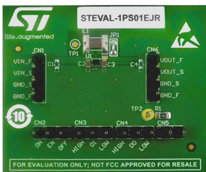
Оценочная плата STEVAL-1PS01EJR на основе 400-миллиамперного синхронного понижающего преобразователя ST1PS01EJR.
