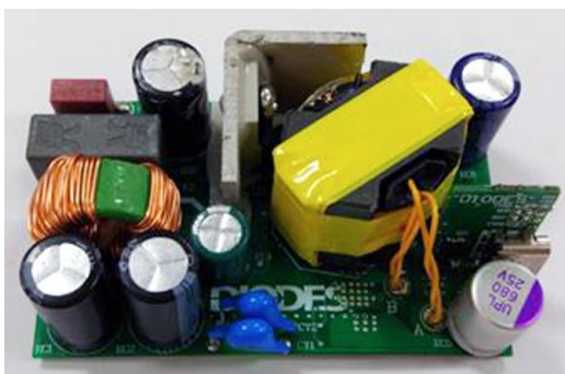
EV2 – оценочная плата 45-ваттного адаптера USB PD 3.0.
