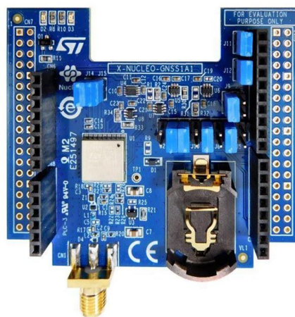
Плата расширения X-NUCLEO-GNSS1A1, основанная на миниатюрном модуле ГНСС Teseo-LIV3F.
