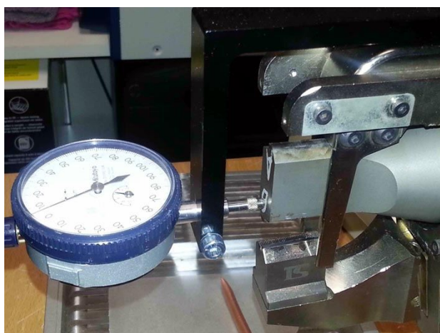
Рисунок 1. Механический ИЧТ при измерении амплитуды колебаний сонотрода.
