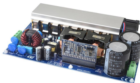
STEVAL-IPFC12V1: 2-киловаттный двухканальный многофазный корректор коэффициента мощности на основе цифрового контроллера STNRGPF12 с цифровым ограничением пускового тока.
