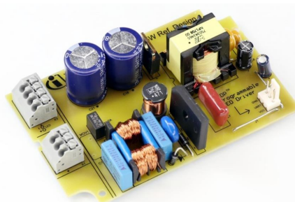
Демонстрационная плата 35-ваттного драйвера-стабилизатора тока на основе XDPL8210 с интерфейсом диммирования 0-10 В.
