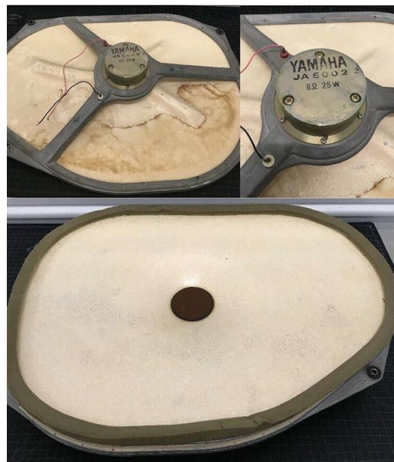
Рисунок 7. Низкочастотный динамик Hi-Fi класса JA5002.
