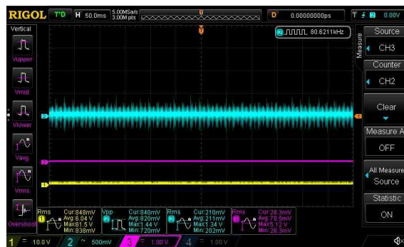
Рисунок 13. Напряжение на выходе при подключенной нагрузке. Регулятор выхода установлен на минимум.
