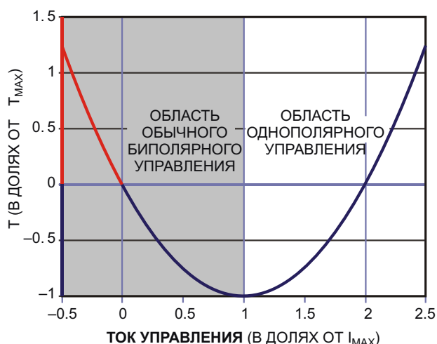
Рисунок 1. Этот график зависимости температуры от максимального тока показывает, что при больших рабочих токах ТЕС, управляемый однополярным драйвером, может обеспечивать как нагрев, так и охлаждение.
