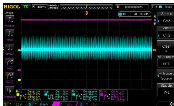
Рисунок 14. Напряжение на выходе при подключенной нагрузке. Регулятор выхода установлен на максимум.
