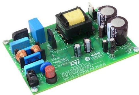
EVLHVLED007W35F – оценочная плата 35-ваттного драйвера светодиодов на основе HVLED007.
