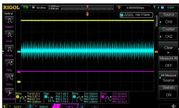
Рисунок 12. Напряжение на выходе в режиме XX. Регулятор выхода установлен на максимум.
