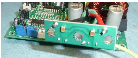
Рисунок 23. Печатная плата выходных клемм после модификации.
