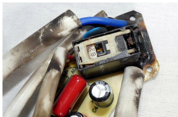
Рисунок 6. Это реле сгорело внутри чайника Cuisinart. Верх удален для просмотра внутренних повреждений, которые были обширными. Негерметичные реле во влажных условиях могут быть источником проблем.
