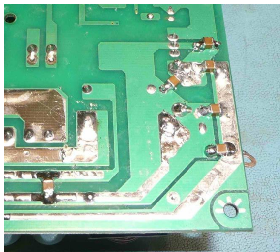
Рисунок 20. Установленные керамические конденсаторы.
