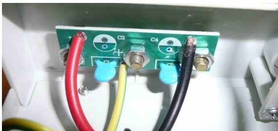
Рисунок 22. Печатная плата выходных клемм до модификации.
