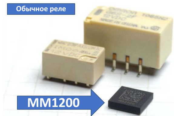
Рисунок 1. МЭМС-реле MM1200 компании Menlo Micro намного меньше обычных реле.
