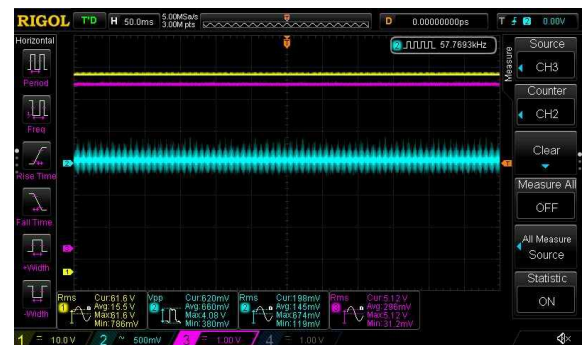
Рисунок 27. ЛИП под нагрузкой. Выходное напряжение установлено на максимум.
