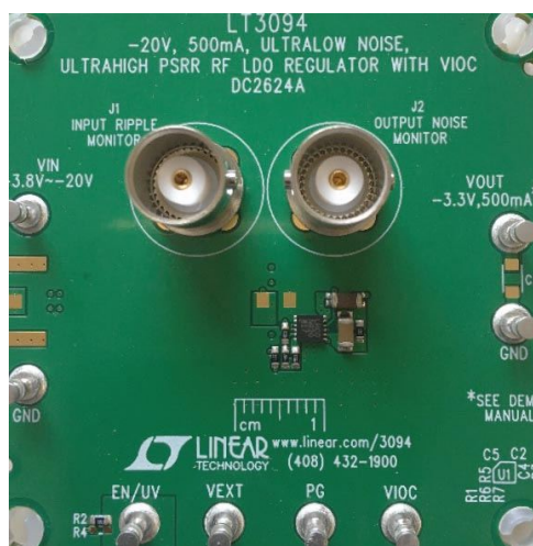
Рисунок 2. Демонстрационная схема крошечного решения для напряжения -3.3 \text{ В} .
