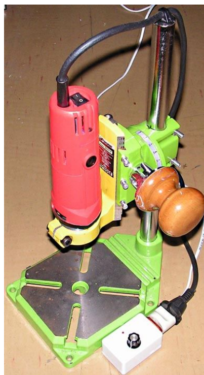
Рисунок 9. Фотография стойки «SKRAB 25519» с мини дрелью «TUNGFULL 1806B» и устройством на базе U2010B в корпусе (в сборе).
