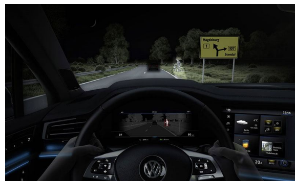
Рисунок 3. Люди или животные на обочине дороги обнаруживаются с помощью инфракрасной технологии и кратковременно освещаются.
