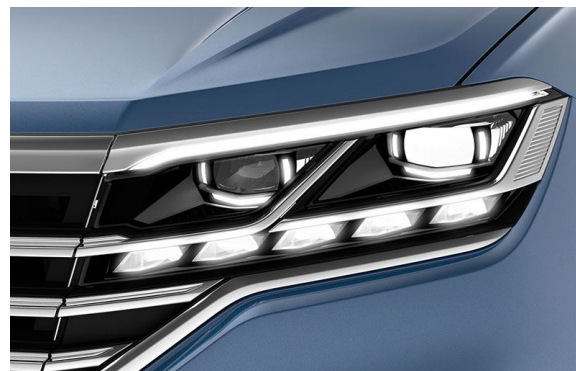
Рисунок 1. Эти интерактивные светодиодные матричные фары IQ.LIGHT имеют централизованное управление.
