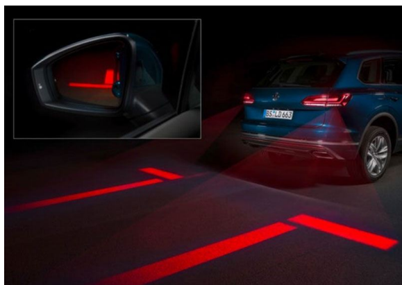
Рисунок 4. Пара красных предупреждающих линий, спроецированных на дорогу при движении автомобиля задним ходом, дает пешеходам представление о границах опасной зоны.
