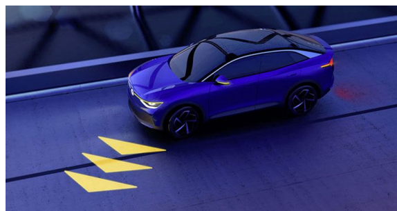
Рисунок 5. Стрелки проецируются на дорожное полотно, указывая на смену направления.
