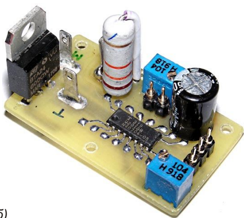
Рисунок 5. Фотография платы на базе U2010B (разводка на Рисунке 3). (а) – вид со стороны SMD компонентов, (б) – вид со стороны навесных компонентов.
