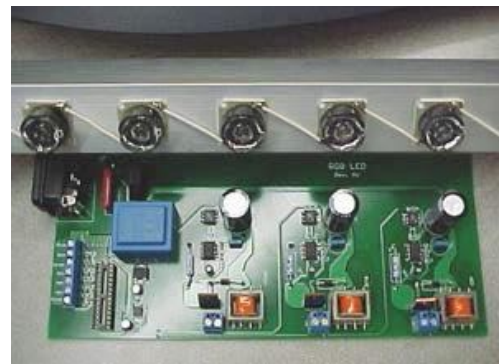
Рисунок 3. Эта версия схемы содержит три канала драйвера постоянного тока. Над печатной платой находится собранная светодиодная панель.
