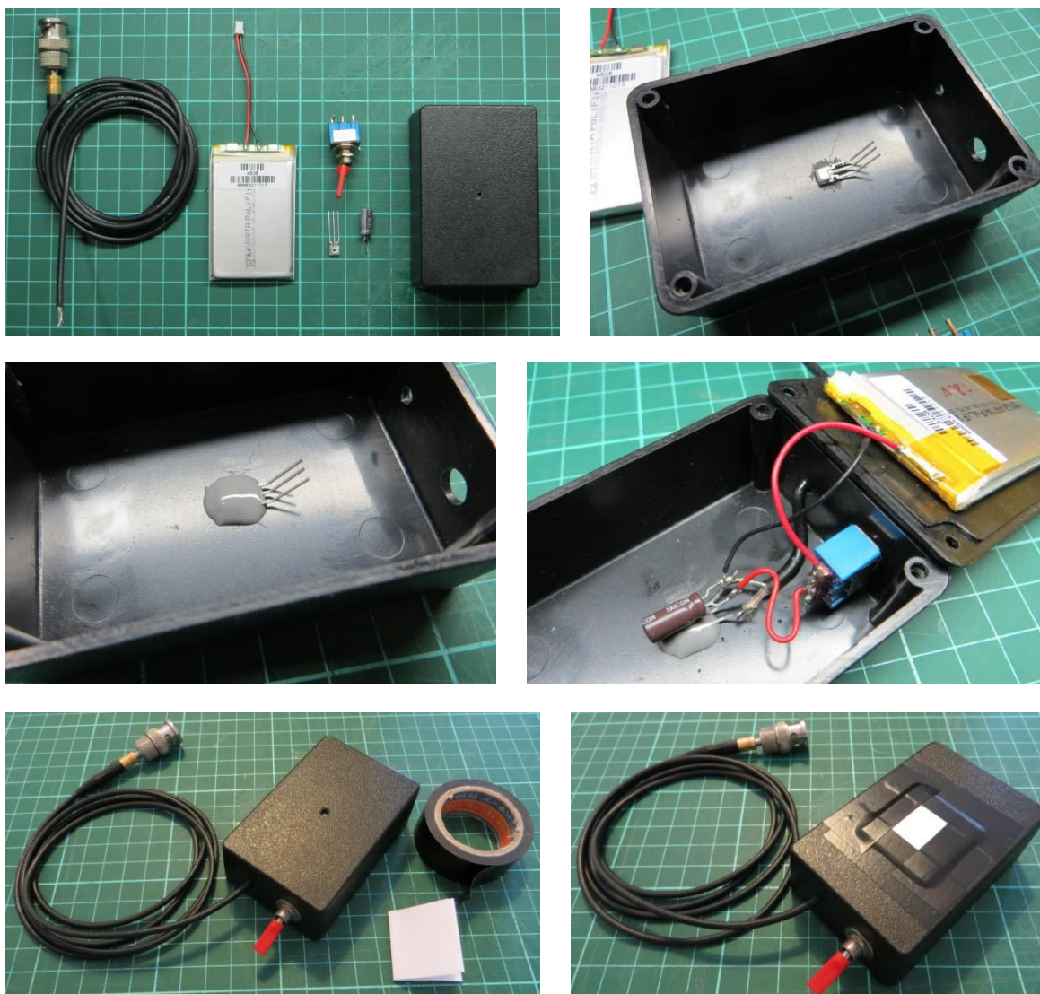
Рисунок 4. Этапы сборки приспособления для измерения мерцания света.
