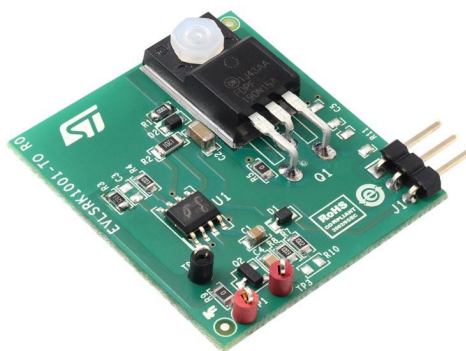
Оценочная плата адаптивного контроллера синхронного выпрямителя на основе SRK1001 для демонстрационной платы обратноходового преобразователя.
