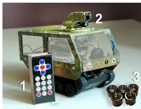
Рисунок 1. (1) – Маяк, (2) – приемопередатчик робота, (3) – объективы 10 градусов.
