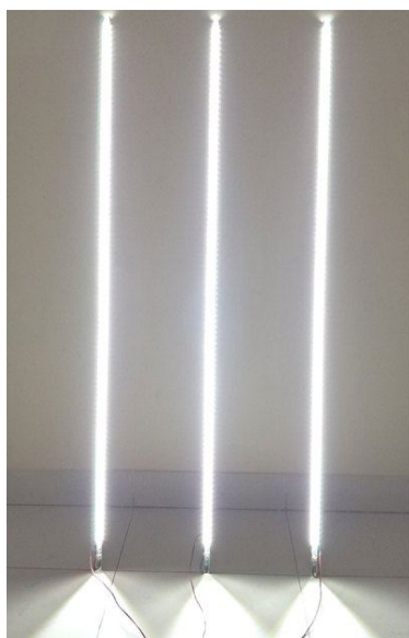
Рисунок 13. Фотография конструкции с 4 фотогальваническими панелями и тремя цепочками по 23 светодиода в каждой.
