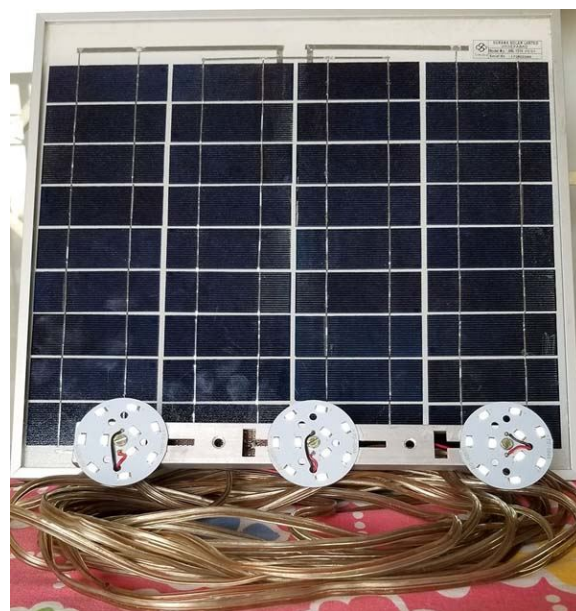
Рисунок 3. Готовая к использованию 10-ваттная солнечная дневная лампа.
