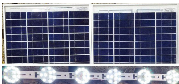
Рисунок 8. 20-ваттная солнечная дневная лампа с активным ограничением тока, готовая к использованию.
