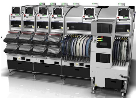
Рисунок 1. Автомат установки компонентов Fuji NXT III.
