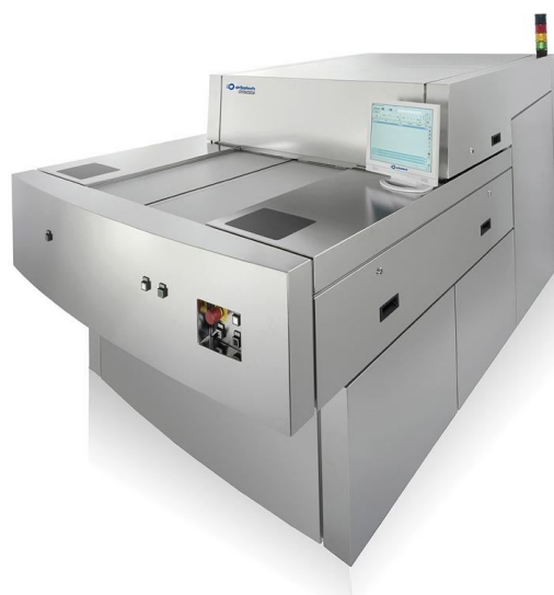
Рисунок 11. Установка Orbotech для прямой визуализации изображений.
