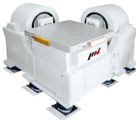
Рисунок 3. Трехосевой вибростенд серии ТС компании IMV Corporation.
