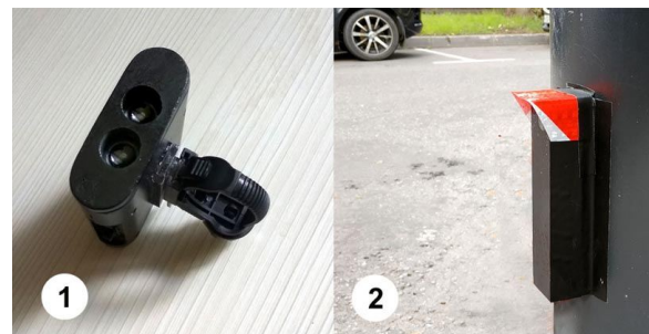
Рисунок 4. Практическое применение генератора с оптической обратной связью. 4.1 – локатор заднего обзора для самоката. 4.2 – фотодатчик для шлагбаума.
