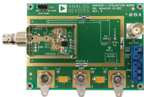
Рисунок 4. Оценочная плата ADA4530-1R-EBZ-TIA.
