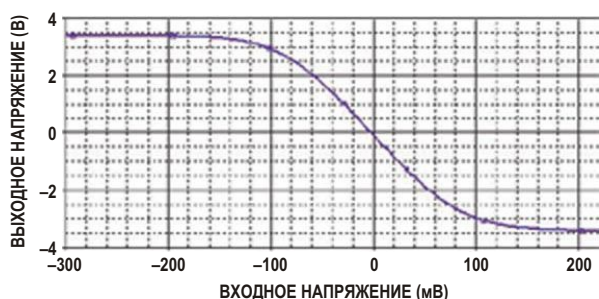
Рисунок 2. Передаточная характеристика нелинейного усилителя показывает постепенное начало ограничения при входном напряжении примерно 100 мВ.
