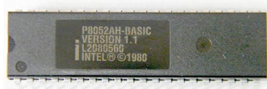
Рисунок 3. Микроконтроллер Intel 8052 с внутренним интерпретатором BASIC. (Фото с сайта http://www.retro-lab.nl )
