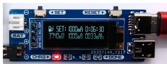
Рисунок 1. TinyCharger - зарядное устройство для одноэлементного Li-Ion аккумулятора с функцией мониторинга.
