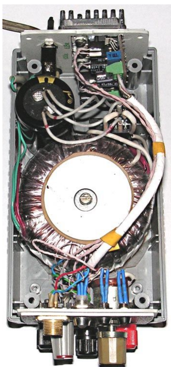
Рисунок 6. Общий вид ИП в открытом корпусе.
