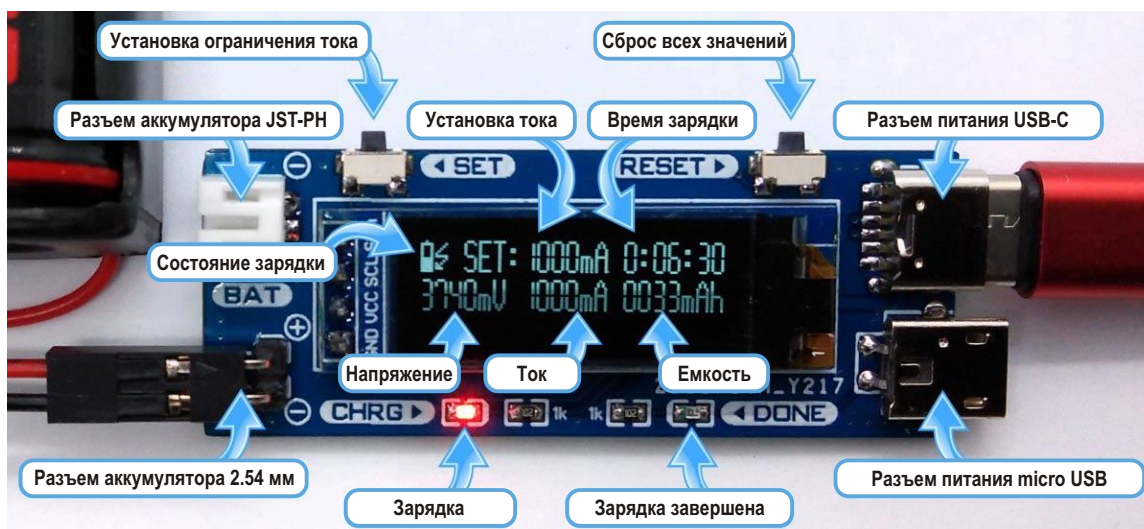
Рисунок 4. Расположение и назначение разъемов, кнопок управления, обозначения на дисплее TinyCharger.
