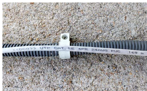
Рисунок 7. UTP-кабель, использованный для SVGA-удлинителя.
