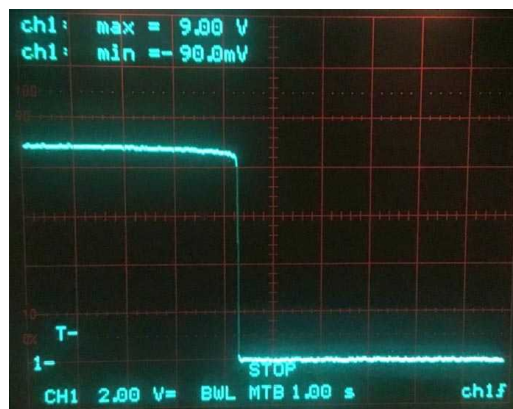
Рисунок 2. Осциллограмма напряжения на нагрузке при отключении питания.
