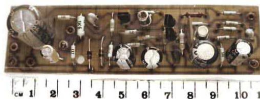
Рисунок 5. Собранный усилитель АРУ размещается на односторонней печатной плате.
