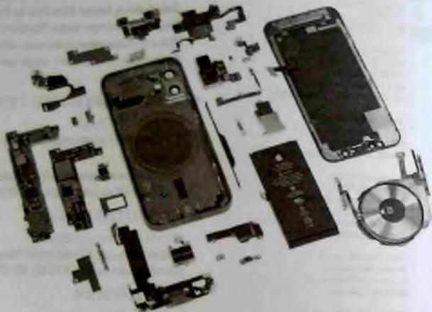
несколько усложняет ремонт. Также дополнительные сложности при разборке iPhone 12 mini порождаются мерами по гидроизоляции смартфона.
