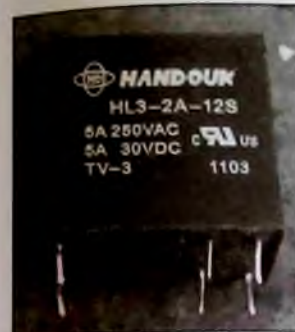
Рис. 15. Внешний вид реле HL3-2A-12S коммутации громкоговорителей
